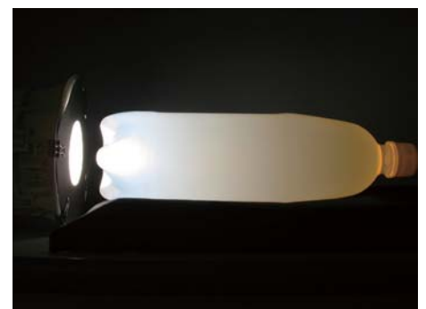
身近な材料（ペットボトルと洗濯用柔軟剤） を使って散乱による空の色を観察
