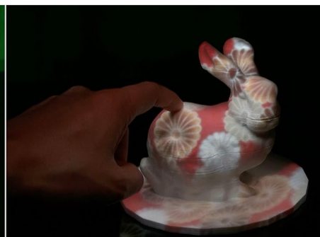
「影なしプロジェクションマッピング」(提案手法) ・・・影の発生を抑制できる
